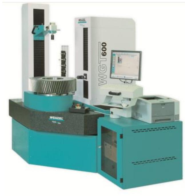
**Figura N°6 – Apparecchio Wenzel mod. WGT600 predisposto per il controllo di alberati.**
