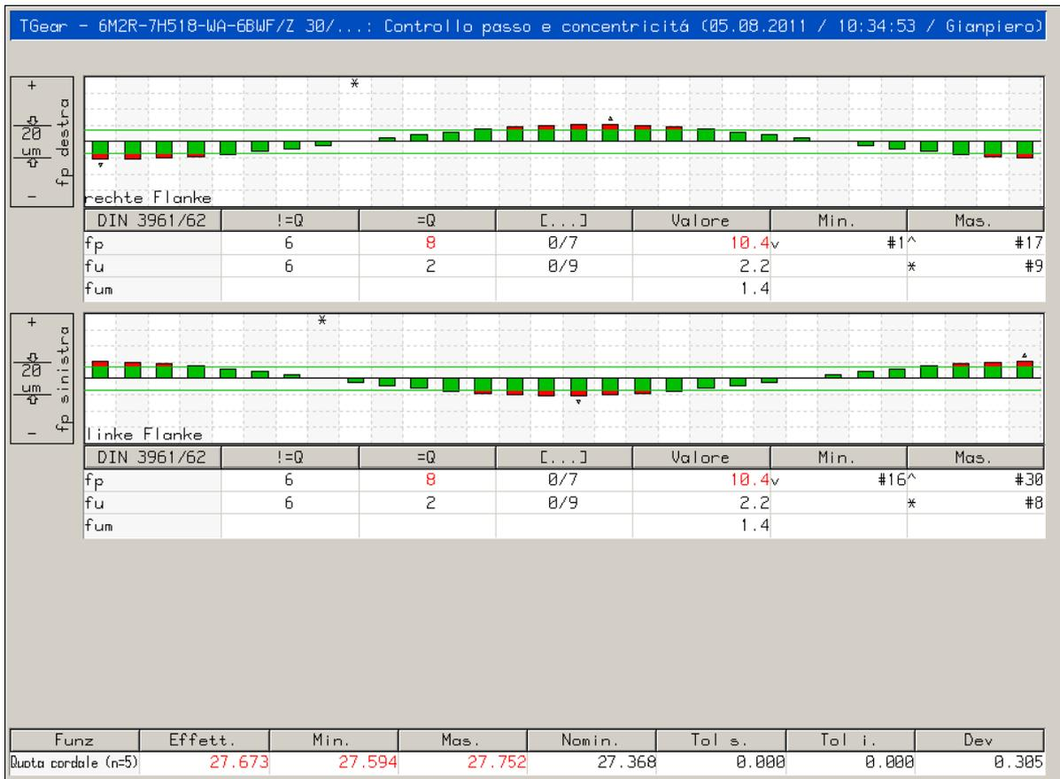
**Figura N°5 – Grafico del controllo di passo ed eccentricità**
